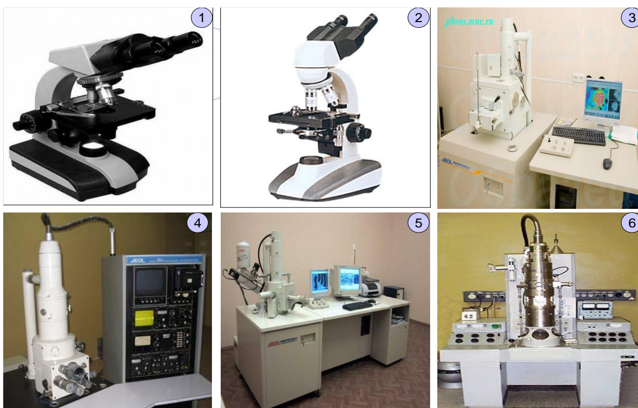
Расм-6. Микробиологик амалиётда қўлланиладиган микроскоплар: 1, 2-бинокуляр биологик микроскоплар; 3,4- Лазерли конфокал микроскоп; 5- Интерференцияловчи компьютерли микроскоп; 6-Электрон микроскоп
