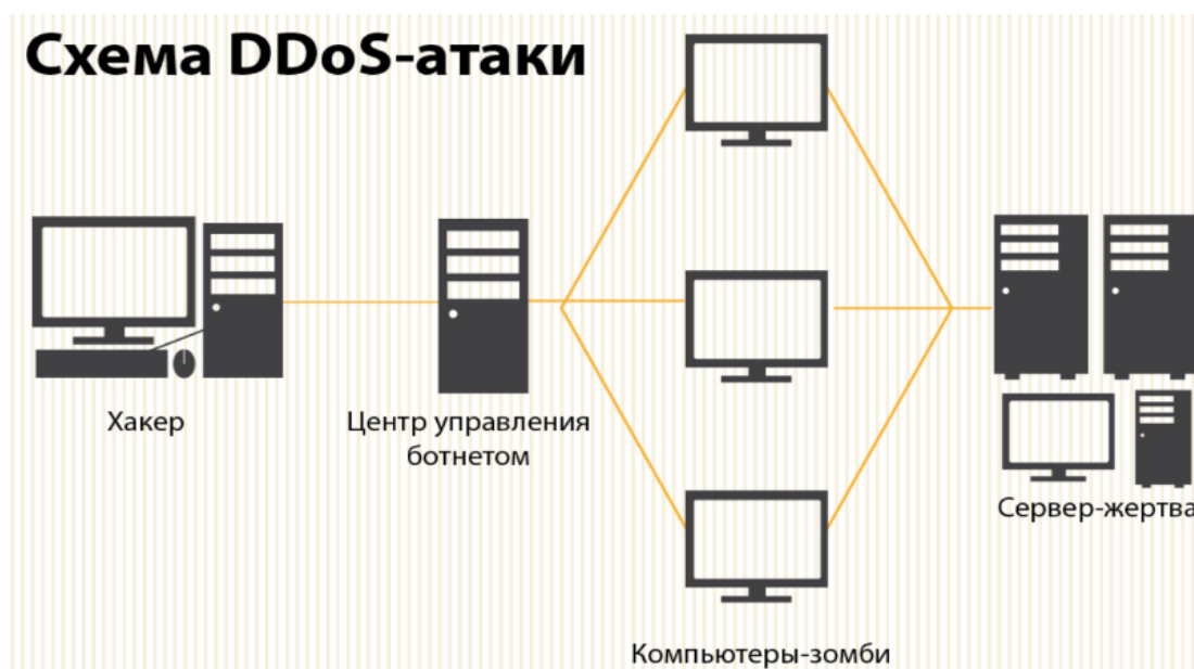
Рисунок 1.6 – Принцип реализации типовой DDoS-атаки
