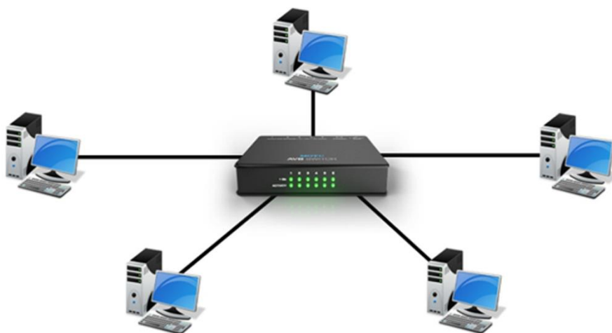
Рисунок 1.1 – Внешний вид концентратора и подключение к нему ПК
